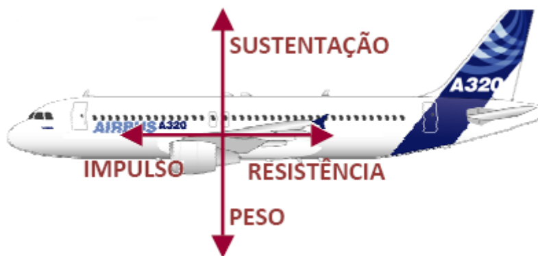
Figura 2.1 – Esquema exemplificativo da direcção das forças do avião em cruzeiro
